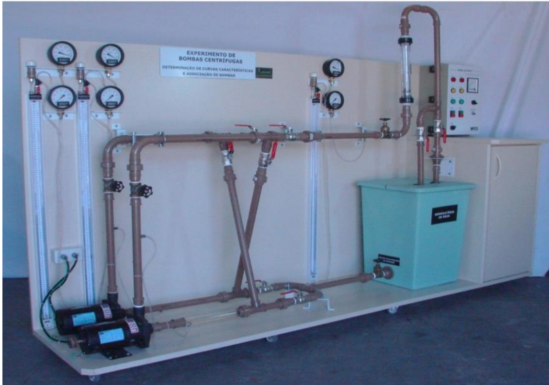
Figura 1. Experimento para determinação de curvas características de bombas centrífugas.
